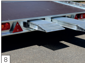
8 Serienausstattung: U-Profil an der Heckseite und Halterung für Auffahrschienen integriert unter dem Ladenboden.
