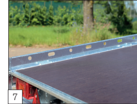
7 Serienausstattung: abgeschrägte Heckseite ca 130 cm und fester Combi Protect Rail seitlich (8 cm hoch).
