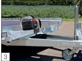
3 Serienausstattung: mit starker, verstellbarer Winde und Windenhalterung.
