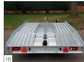
16 Option: Mit gelochtem Fahrschienenprofil anstelle Multiplex Boden, zwischen den Fahrschienen ist der Anhänger offen.
