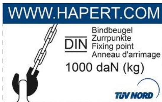
Verwenden Sie zum Ladungssicherung nur solide, dafür bestimmte Zurrgurte, die die EN 12195-2 erfüllen.
