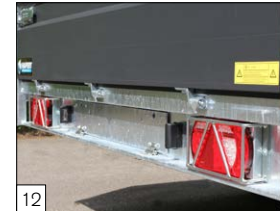
12 Standaard: LED verlichting aan achterzijde.
