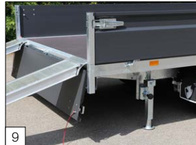
9 Standaard: U-profiel aan de achterzijde.
