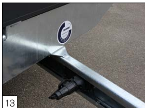
13 Standaard: weerstands-unit gemonteerd ten behoeve van LED-verlichting.
