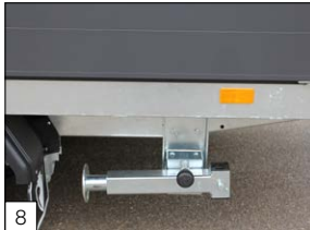
8 Standaard: de steunpoten zijn verstelbaar en 90° draaibaar.
