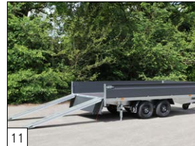
11 Standaard: oprijpakket gemonteerd (oprijbalken en steunen).
