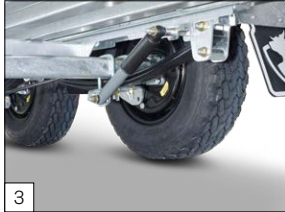
3 Standaard: paraboolvering incl. schokbrekers op de assen.
