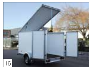
Optie: deksel scharnierend aan de voorzijde (mogelijk tot max. afm. van 300 x 150 x 180 cm).
