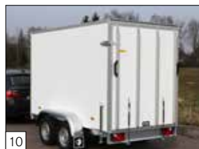
Optie: achterklep op gasveren en voorzien van dubbele sluiting links en rechts.
