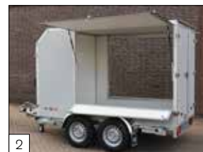
Optie: links en rechts een zijklep en daaronder een tassen-drager gemonteerd (klepje ca. 20 cm naar beneden scharnierend), opbouw in lichtgrijs aan de buitenzijde.
