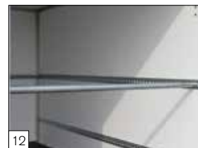
Optie: ladingvastzetsysteem in de gesloten opbouw voorzien van spanbus en spanband.
