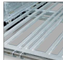
Tous les modèles Indigo ont un châssis entièrement soudé et galvanisé. Le modèle LF est également doté de longerons supplémentaires. Ce modèle est fabriqué de série avec un plancher multiplex.
