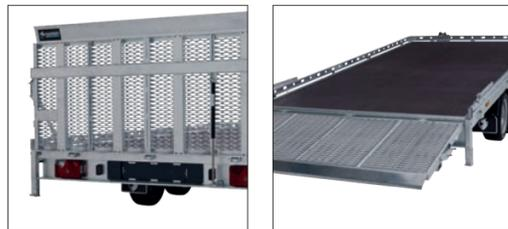
Le modèle HT est doté de série d'un hayon arrière de 1000 mm de hauteur. Le rabat galvanisé est équipé d'un ressort pneumatique pour une utilisation aisée, et est fabriqué avec un profilé antidérapant. Cette rampe sur toute la largeur est parfait pour le transport de machines. Pour le transport de voitures est bien l'option rampes intégrées. On peut choisir les dimensions 2 000 / 2 500 et 3 500 mm de longueur.
