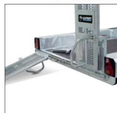
Les modèles LF sont équipés en série à l'arrière d'une rampe en acier sur toute largeur d'environ 1 500 mm de hauteur avec support et verins. On a aussi l'option avec 2 rampes réglables en largeur de 1 500 mm. de hauteur avec supports. Les rampes sont fabriquées à l'aide d'un profilé antidérapant ouvert et sont réglables et galvanisées.
