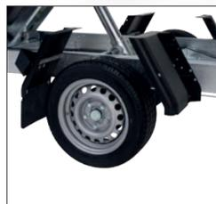
Les modèles HB sont pourvus de série d'un plancher surbaissé équipé de pneus 195/50 R13.
