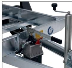
Les modèles HB sont équipés d'un système hydraulique avec une pompe manuelle solide. Une pompe électrique avec batterie est disponible en option.
