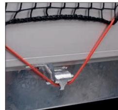
Des charnières articulés ingénieux supplémentaires sont installés sur les modèles de base HB et HM. Le crochet permet de fixer aisément le filet de chargement.
