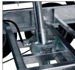
Toutes les bennes HAPERT sont équipées d'un vérin hydraulique solide et à 3, 4 ou 5 positions selon les dimensions.
