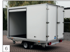
6 Option : volet roulant (dimensions maximales : 210 cm de hauteur x 150 cm de largeur) s'ouvrant dans la paroi latérale.
