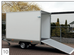
10 Option : rampe d'accès arrière avec revêtement gris anti-dérapant. Rampe d'accès équipé de ressorts à gaz.
