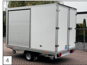
4 Option : volet roulant en aluminium (dimensions maximales : 180 cm de hauteur x 150 cm de largeur) s'ouvrant dans la paroi latérale.
