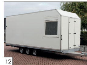
12 Option : remorque à trois essieux avec fenêtre et partie avant inclinée (angle d'environ 40 x 40 cm).
