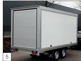
5 Option : volet coulissant en aluminium à l'arrière et protection de l'éclairage.
