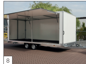
8 Option : grand hayon de vente latéral avec montant central d'appui.
