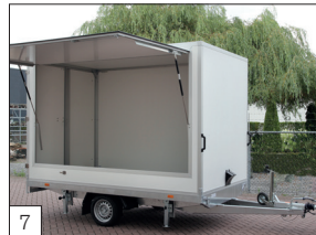
7 Option : hayon de vente latéral avec partie inférieure de la paroi latérale fixe et 4 béquilles.
