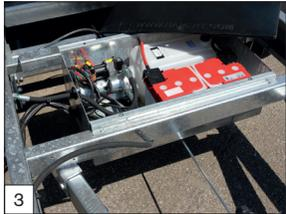
**En série :** pompe électrique avec batterie située dans une caisse en acier galvanisée, recouverte d'un couvercle plastique.
