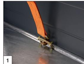
**En série :** système d'arrimage de chargement HAPERT certifié par TÜV. Les anneaux d'arrimage intégrés dans les côtés ont une capacité de 1000 daN.
