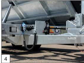
**En série :** commande de pompe avec câble amovible et pompe manuelle de secours montée.
