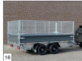
**Option :** réhausse grillagée de 75 cm. de hauteur et ridelle arrière pivotante en deux sens.
