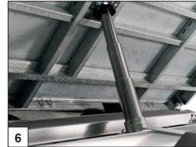
**En série :** En série: un solide vérin hydraulique intégré avec 5-étages et un plancher "FERRO": un plancher monobloc en acier galvanisé à chaud de 3mm d'épaisseur.
