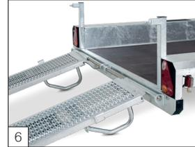
**Option :** 2 rampes de chargement en acier galvanisé de 1 500 ou 2 000 mm de long, articulées à l'arrière.
