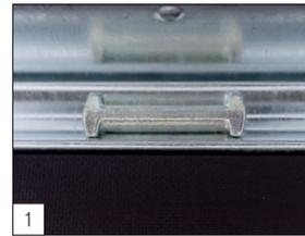
**En série :** supports d'arrimage avec une capacité de 1 000 daN intégrés dans le plancher.
