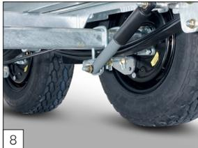
**Option :** suspension parabolique avec amortisseurs.
