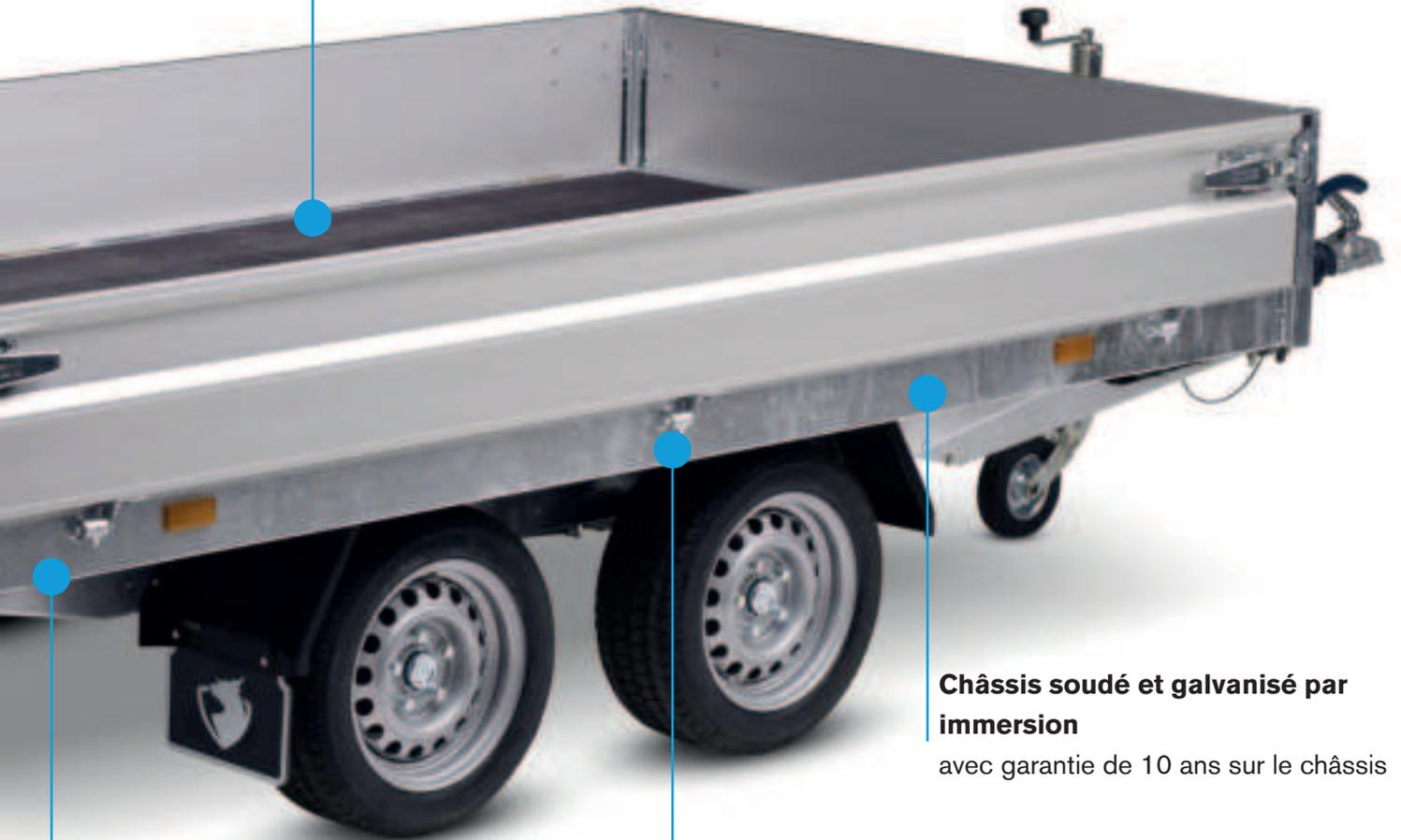
**Châssis soudé et galvanisé par immersion**
