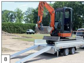
8 Optie: Oprij-pakket: 2 aluminium oprijbalken geïntegreerd onder de vloer en 2 stabiele verstelbare uitzetpoten incl. slinger.
