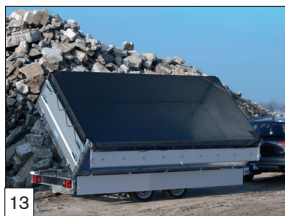
13 Optie: pendel-opzetborden met fijnmazig ladingnet (gemonteerd).
