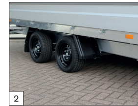
2 Standaard: rondom zijn extra bord-scharnierpunten met haak gemonteerd.
